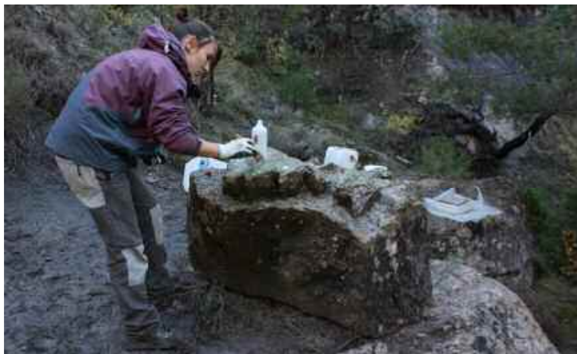
Aplicación de un producto desmoldeante para evitar que la silicona se adhiera a la roca. FCPTD-D:A.
