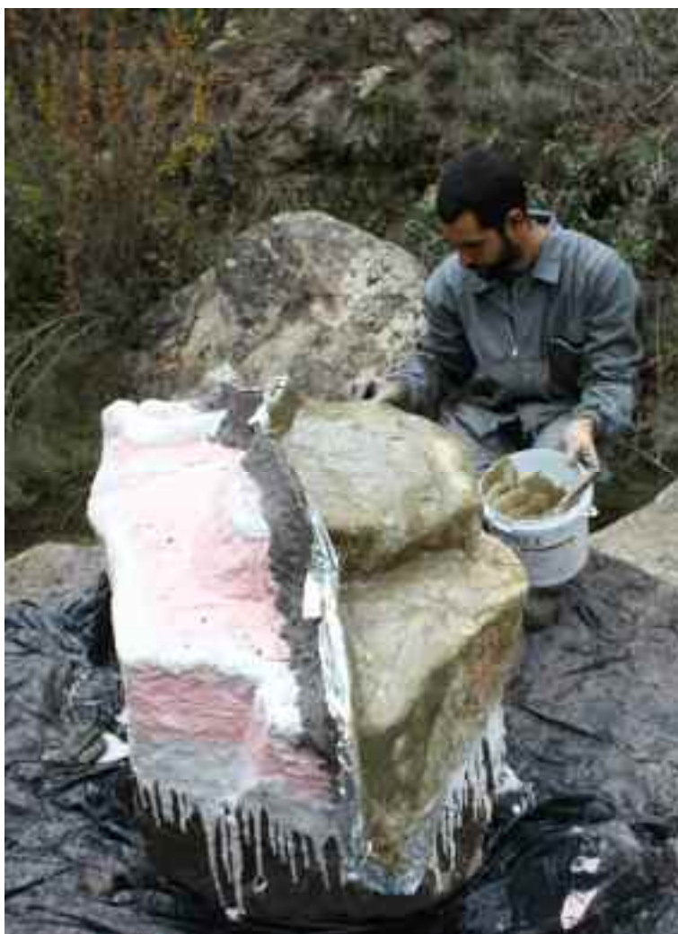
Confección de una carcasa rígida de resina sobre la matriz de silicona para evitar su deformación. FCPTD-A:G;
